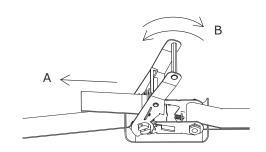
通したベルトを矢印 A の方向へ引っ張り、緩みをとります。緩みをとったまま ハンドルを矢印 B の様に反復させるとベルトが徐々に締まっていきます。ベルトは巻取軸に最低 2 巻き以上巻き取ってください。巻き足らないとベルトが緩む原因になります。
