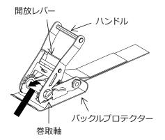
ベルトに縫い付けている縦ライン側を上にし、バックルプロテクターの下面からバックル本体にある巻取軸にベルトを通します。
